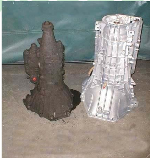
Gambar 2.3.2 Contoh Hasil Sandblasting
