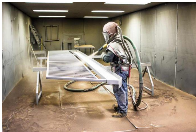
Gambar 2.3.1 Contoh Proses Sandblasting
