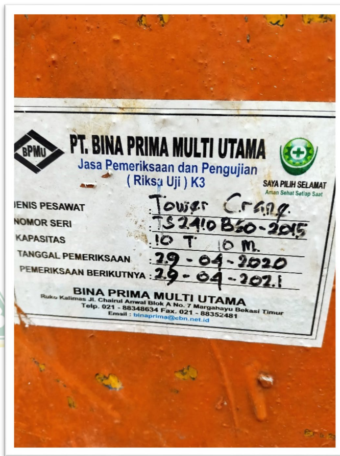
Gambar 4. 16 Pemeriksaan riksa K3 Tower Crine
