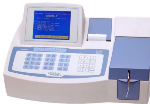
Gambar 3.3 Spektrofotometer Erba Mainnheim CHEM-7 19
