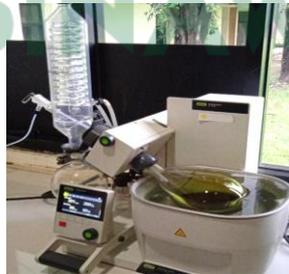
Gambar penguapan maserat dengan mesin evaporator
