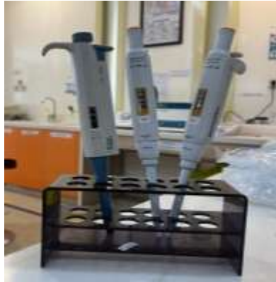
Mikropipet Alat Untuk Memipet Sampel
